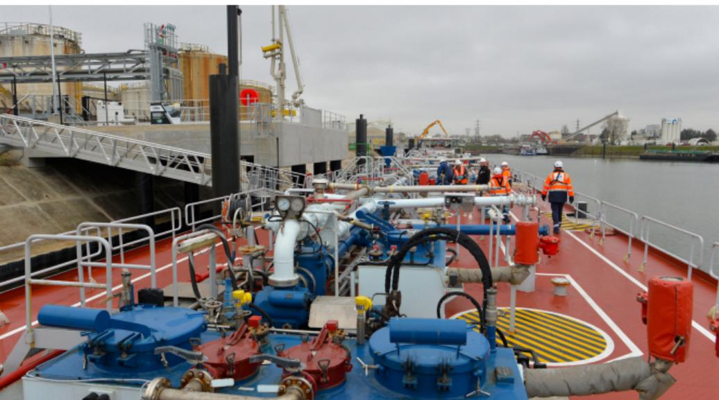
Déchargement d'une barge transportant de l'éthanol, opérée par l'armateur **Sogestran**, sur le terminal fluvial du dépôt **SOGEPF** de Gennevilliers. Cette unité fluviale a livré de l'éthanol transbordé en bord à bord au Havre depuis un navire maritime.
