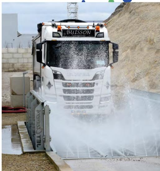
projetant pas moins de 1 400 litres d'eau en 20 secondes. Cette eau est ensuite récupérée et décantée dans 3 bassins successifs, afin de pouvoir la réutiliser pour laver les roues des véhicules suivants. Les boues issues de la décantation quant à elles curées et valorisées directement sur le site d'exploitation. Un système de nettoyage vertueux et écologique.
